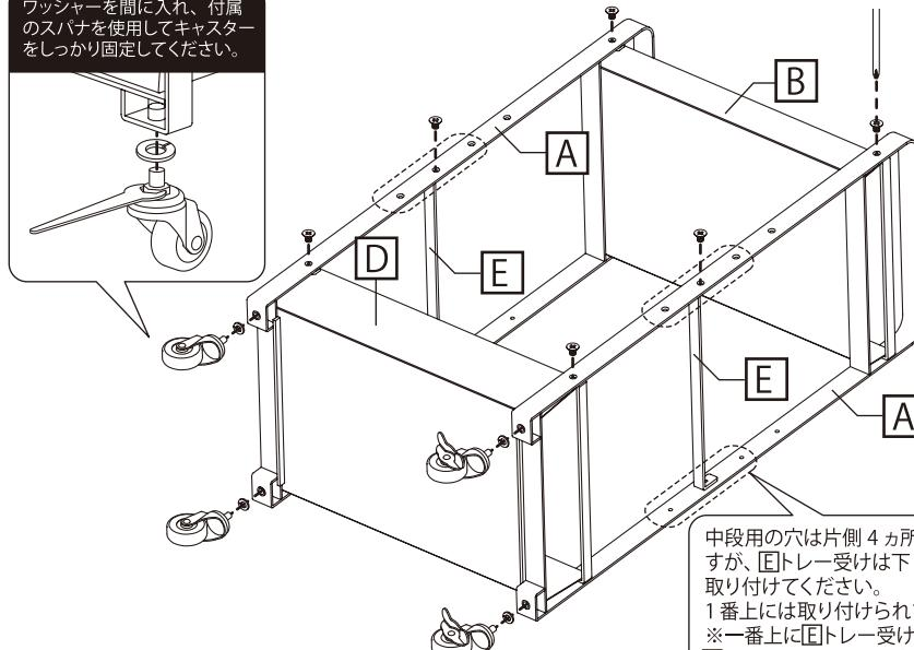
中段用の穴は片側4カ所ずつ空いていますが、**E**トレー受けは下3カ所を使用して取り付けてください。
