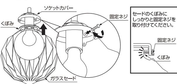
**警告** ネジを固定した後に再度、ガラスセードがしっかりとソケットカバーに固定されているか確認してください。
