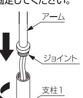
支柱1を手で持ち、ジョイントを穴に合わせ、支柱2を左に回して固定してください。
