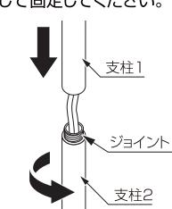
○ コードが捩じれていくと断線の恐れがあるため、必ず下に取り付ける支柱を回してください。
