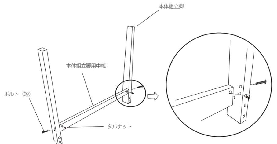
タルナットにボルトが入るように、あらかじめタルナットの向きを決めてからボルトを取り付けてください。
