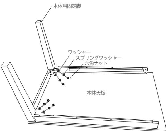
**02** 本体の組立脚を組立ます。組立には、本体組立脚・本体組立脚用中棧・タルナット・ボルト (短)を使用してください。
