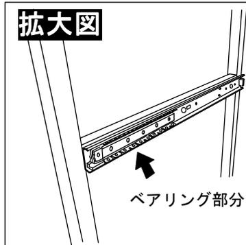
※左図のベアリング部分が手前にある状態で引出しを取付けて下さい。
