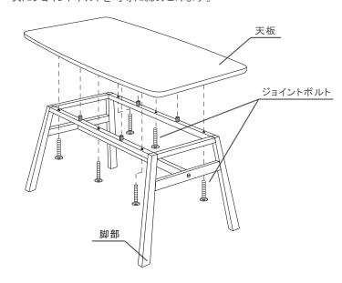
**103** 十分にボルトが締まっていることを確認してください。ボルトに緩みがあると ガタつき、本体の破損の原因になることがあります。
