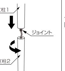
○ コードが捩じれていくと断線の恐れがあるため、必ず下に取り付ける支柱を回してください。
