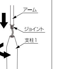
支柱1を手で持ち、ジョイントを穴に合わせ、支柱2を左に回して固定してください。
