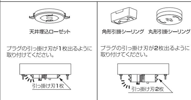
この時、回転防止ツメにプラグの引っ掛け刃が接触しないようにしてください。落下の原因となります。
