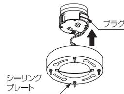
**警告** 天井配線器具によって取り付け完了時のシーリングプレートの位置が違います。
