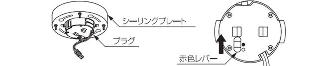
**警告** プラグの引っ掛け刃が回転防止ツメに接触している場合は赤色レバーが動きません。必ずプラグの引っ掛け刃が完全に出た状態で赤色レバーを「●レバーロック」に合せてください。
