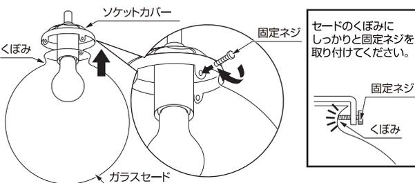
**警告** ネジを固定した後に再度、ガラスセードがしっかりとソケットカバーに固定されているか確認してください。
